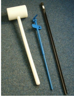
Pürckhauer Bohrstock mit Kunststoffhammer und Ziehgerät.
