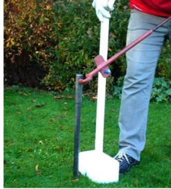
Ziehvorgang des Bohrstocke
